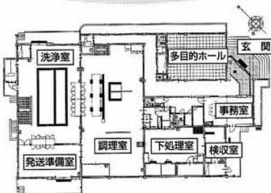
施設は、検収室、下処理室、調理室、洗浄室など作業工程毎に独立させ、ドライ方式により床を乾燥させ食中毒の発生に対処しています。また、厨房設備は新鋭機材の導入により、衛生面と効率性を備えた設備を計画しております。調理能力は、1日1200食で学校給食はもとより、災害、福祉などにも対応できるよう設計されています。
