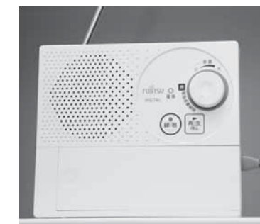
▲各世帯に設置している戸別受信機
