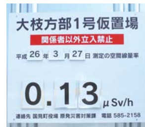
③施設の監視と線量等の表示
