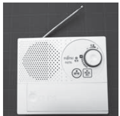
各世帯に設置されている防災行政無線
