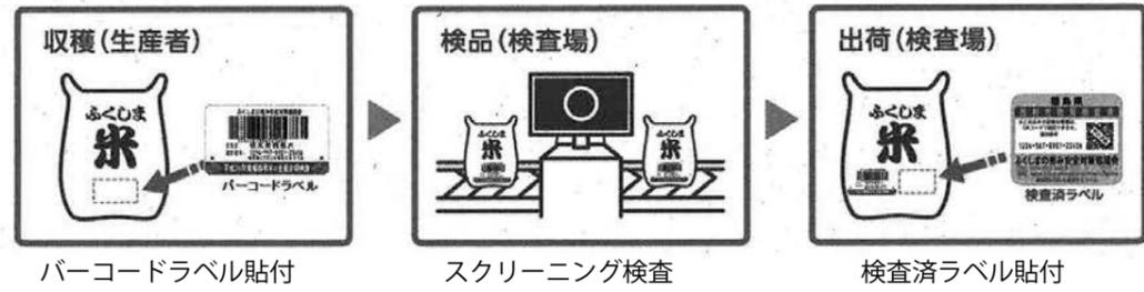
生産者及び個体識別するバーコードラベルを貼付け、1袋ずつベルトコンベヤー式検査機で測定
